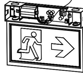
Schließen Sie den Batterieverbinder an die passende Buchse auf dem Elektronikmodul an.
