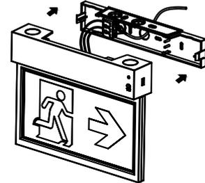
Schließen Sie den Verbinder an das Elektronikmodul an und rasten Sie die Leuchte in die Montageplatte ein.
