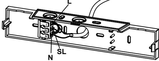
Schließen Sie das Kabel an den Anschlussklemmen an. Beachten Sie die untenstehenden Verdrahtungshinweise.
