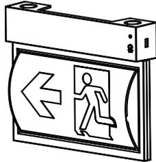
Entfernen Sie ein evtl. eingelegtes Piktogramm, legen Sie das benötigte Piktogramm ein und führen Sie die Ränder in den Rahmen.
