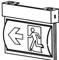
Entfernen Sie ein evtl. eingelegtes Piktogramm, legen Sie das benötigte Piktogramm ein und führen Sie die Ränder in den Rahmen.
