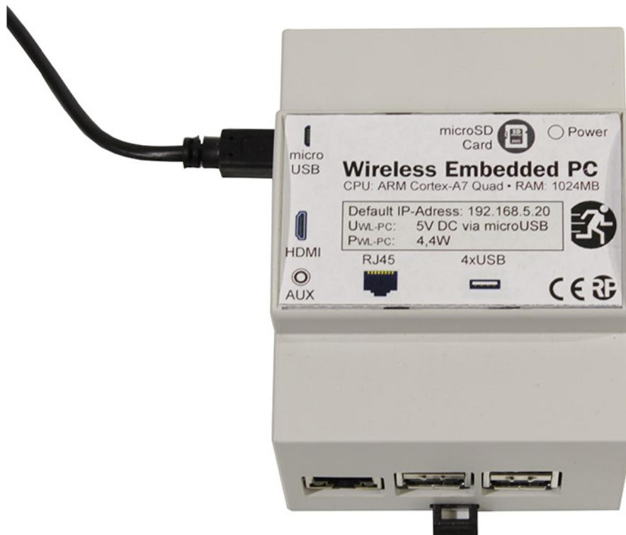
Wireless Professionell Embedded-Computer mit separatem Netzteil im Hutschienengehäuse.
