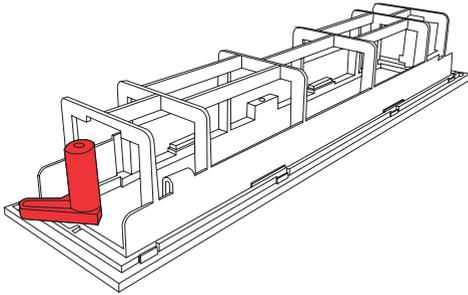
Entfernen Sie die in der Zeichnung rot markierten Kunststoff-Halteklammern mit einem Messer oder Seitenschneider vom Einbaurahmen.
