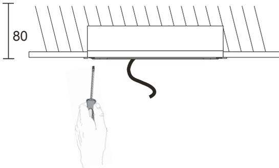
Setzen Sie die Leuchte in den Rahmen. Achten Sie darauf, dass die Leuchte im Einbaurahmen einrastet.
