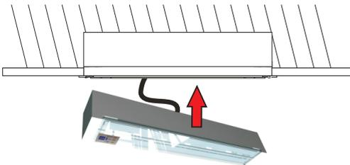
Verschließen Sie den Einbaurahmen mit dem Blendrahmen.
