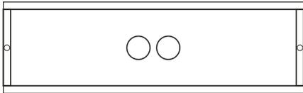
Setzen Sie den Kunststoffrahmen in den Einputzkasten und schrauben ihn mit den Senkkopfschrauben seitlich fest.
