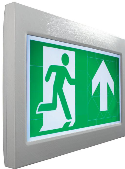
Robuste Zink-Druckguss Rettungszeichenleuchte zur zur dynamischen Fluchtweglenkung. Es stehen sowohl im Normalbetrieb, als auch im aktivierten Betrieb 10 Anzeigeoptionen zur Verfügung. Die zwei Betriebszustände sind auf einfache weise per Drehkodierschalter wählbar.
